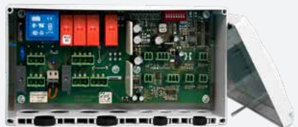
Für zusätzlichen Komfort bietet SIGMATEK eine dezentrale Steuerungslösung außerhalb des Kessels mit speziell entwickelten Modulen. Erweiterungen für Heizkreise, Solar, Puffer, Boiler und Fußbodenheizung sind gut geschützt in Kunststoffgehäusen untergebracht und mittels Plug & Play einfach erweiterbar.
