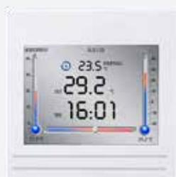
Das Touch Panel HZS 351 bzw. 352 ermöglicht eine komfortable Raumsteuerung. Über das 3,5 Zoll TFT-Farbdisplay sind Prozessdaten und Parameter einfach einzugeben. Um Energie zu sparen, ist das Display im Ruhezustand deaktiviert. Bei Berührung des Touches wird das Panel sofort aktiv. Eine Wandmontage ist in einer Unterputzdose möglich.
