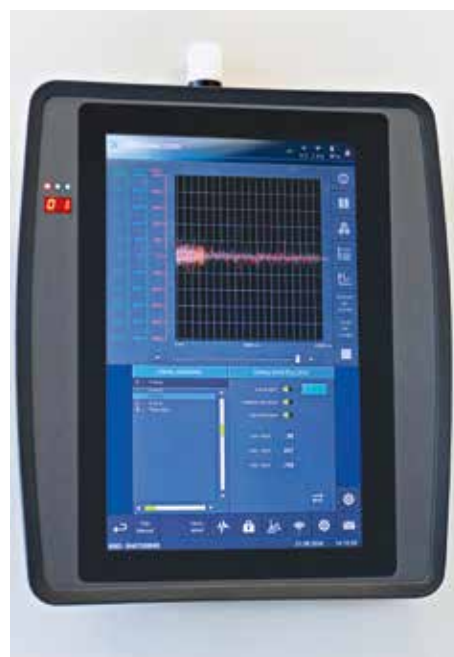
Die Oszilloskop-Funktion des Wireless-Panels erlaubt dem Bediener, ein Signal in Echtzeit zu beobachten, um mögliche Anomalitäten festzustellen.
