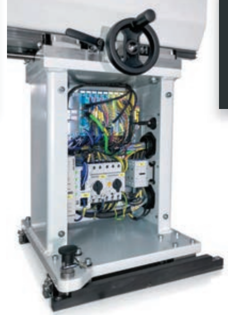
Die robusten, kompakten und modularen »S-Dias«-Steuerungs- und I/O-Module von Sigmatek sitzen direkt im Standfuß des Bürstroboters.
