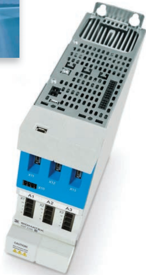
Das kombinierte Versorgungs-/Achsmodule »Dias-Drive MDP 2100« bietet 3x 5 A Nenn- bzw. 15 A Spitzenstrom und misst in der Breite 75 mm, in der Höhe 240 mm und in der Tiefe 219 mm.
