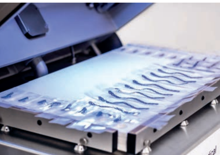
Die Kammermaschine von ist fertig beladen und für den Vakuumier-Prozess bereit.
