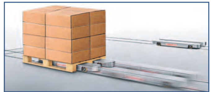
Die Doppelkufen des LogiMovers passen genau unter eine Euro-Palette, heben diese an und transportieren sie automatisch an den gewünschten Ort.
