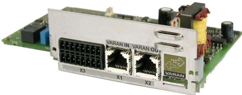
Dieses VARAN Interface Modul dient zur Kommunikation zwischen einem DIAS-Drive und einer Steuerung mittels VARAN-Bus. Es ist in der DIAS-Drive Serie 300 eingebaut.
