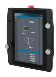
Das HGW 1033-32 ist in Kombination mit einer Basisstation BWH 001 sowie einer sicherheitsgerichteten SPS, ein kabelloses, intelligentes Handbediengerät mit Not-Halt-Funktion, welches die Programmierung, Visualisierung und Diagnose von Prozessen sowie die Steuerung von Anlagen ermöglicht.
