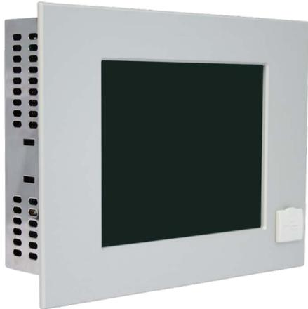
Das HZS 555-S ist ein intelligentes Terminal zur Programmierung und Visualisierung von automatisierten Prozessen. Die Prozessdiagnose sowie die Bedienung und Beobachtung von automatisierten Abläufen werden durch dieses Einbausterminal vereinfacht. Über den CAN-Bus wird es an das Leistungsteil angeschlossen. Ein Touch-Screen dient zur Eingabe von Prozessdaten und Parametern. Die Ausgabe erfolgt auf einem 5,7" VGA TFT-Farbdisplay.
