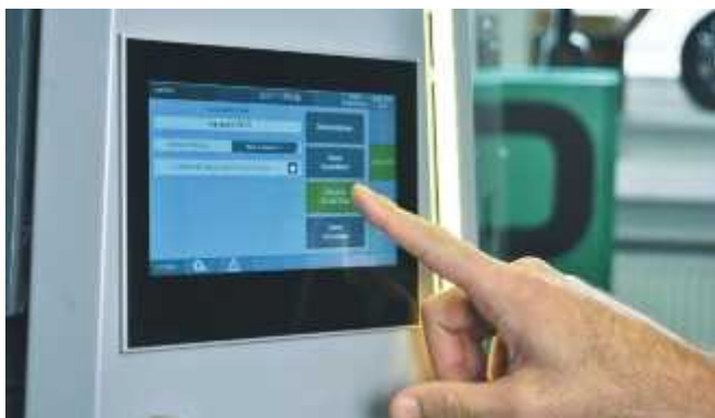
Zentrales Element der Steuerungstechnik: Bedienpanel ETT 732 mit 7 Zoll Dual-Touch TFT-Farbdisplay und Edge2-Technology-Prozessor.
