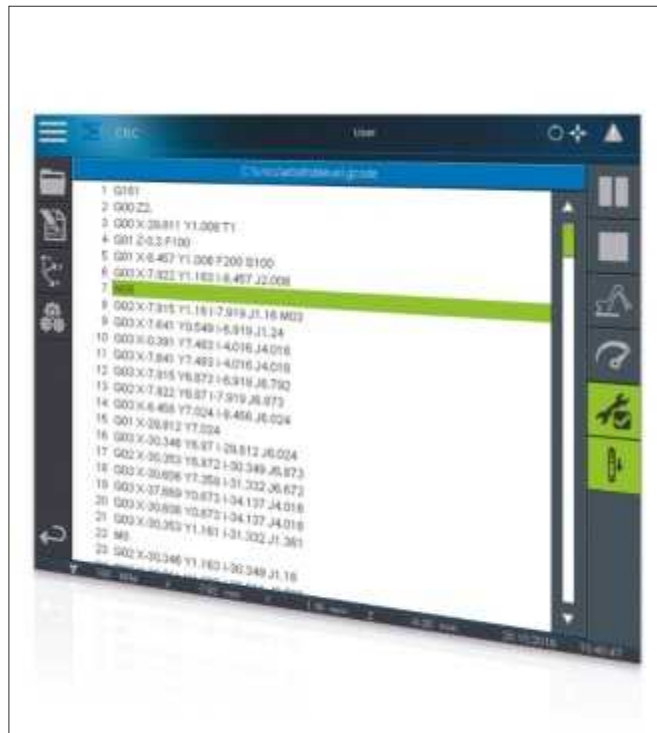
Der G-Code-Interpreter ist Bestandteil der Engineeringumgebung Lasal und wurde um die sequenzielle Bearbeitung von großen Programmen erweitert.
