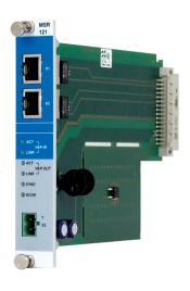
Über dieses Modul werden der VARAN-Bus und der Versorgungsstecker auf die Ebene der Frontplatte herausgeführt. Zusätzlich beinhaltet das Schnittstellenmodul eine Einschaltstrombegrenzung. Um eine Verstecksicherheit zu garantieren, ist der DIN-Stecker (Verbindung zum Modulträger) gegenüber I/0 Basis bzw. Lüftermodul versetzt angeordnet.
