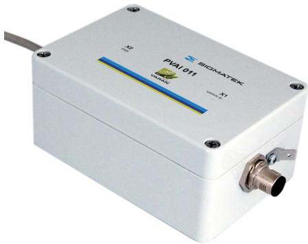
Es kann eine Messbrücke in den Auflösungen 1,1 mV/V in 4-Leitertechnik angeschlossen werden. Die Brückenspeisespannung beträgt 10 V. Der minimale Brückenwiderstand der Messbrücke ist 100 Ω.
