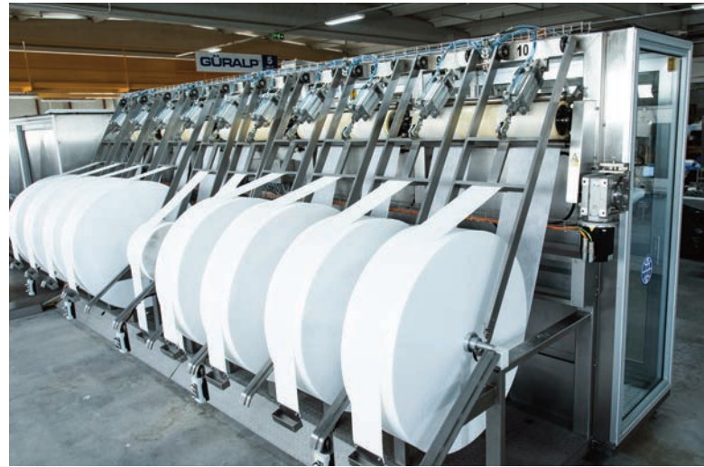
► Bei der Feuchttuch-Verarbeitung sind zwischen 10 und 24 Vlies-Rollen im Einsatz.
