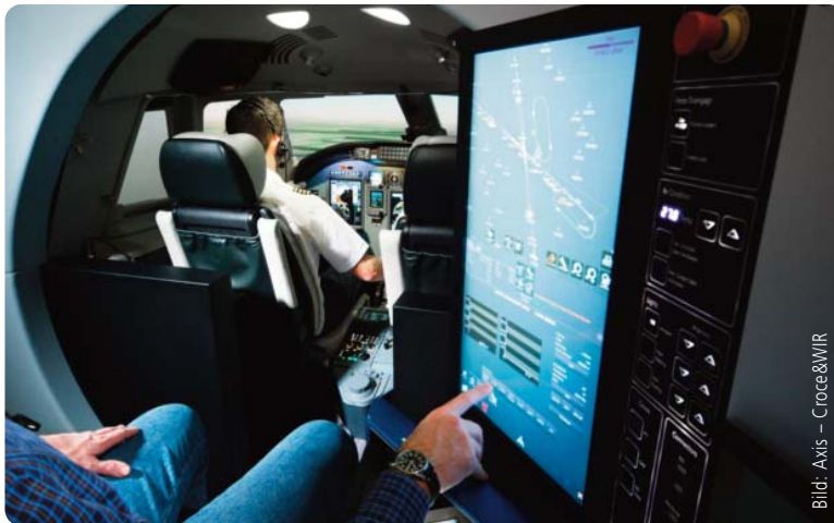
Bild 4: In der Kabine befindet sich hinter den Pilotenplätzen die sogenannte Instructor Operating Station. Hier sitzt während der Simulation der Trainer, steuert die Simulation und aktiviert unterschiedlichste Flugszenarien.
