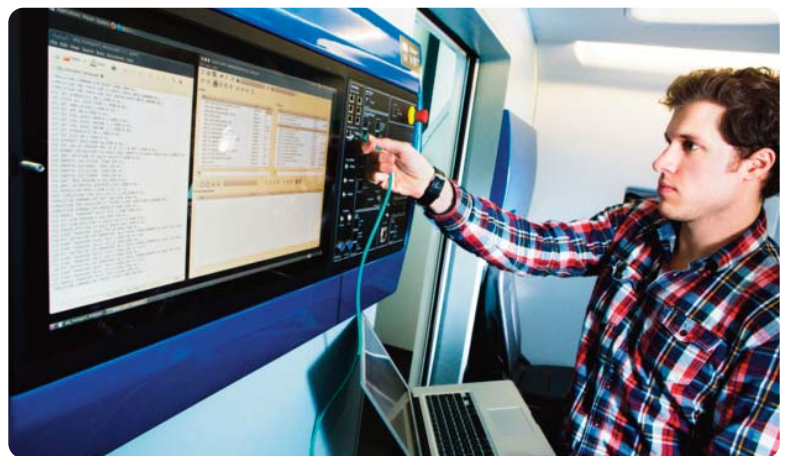
Bild 5: Über das von außen leicht zugängliche Maintenance-Panel lassen sich die vorgeschriebenen regelmäßigen technischen Überprüfungen des Simulators rasch durchführen – das erhöht die Verfügbarkeit.
