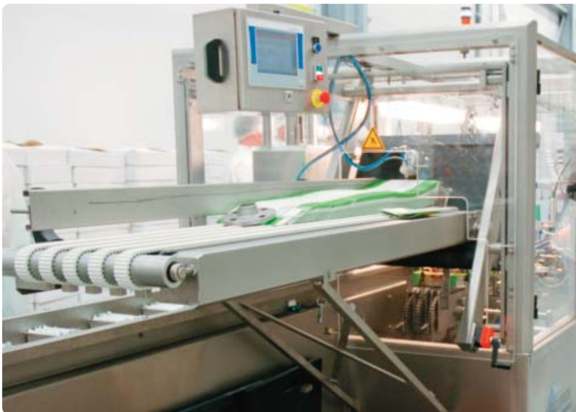
Bild 2: In ihre Überverpackung gelangen die einzelverpackten Riegel auf der Kartonniermaschine RTC 220 Slimline. Steuerung, Bedienung und Visualisierung der Maschine erfolgt über das Control Panel ETV 0811 mit 8,4"-TFT-Farb-Touchscreen von Sigmatek.
