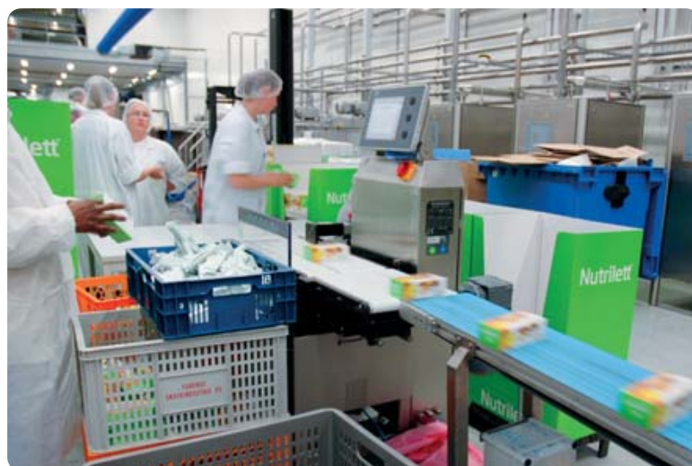
Bild 4: Als fertig verpackte Einheiten – in diesem Fall zu je vier Stück – verlassen die Riegel die Verpackungsmaschine.
