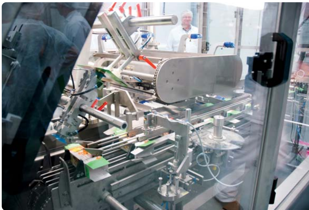
Bild 3: Ein komplexer Mechanismus mit Saugnäpfen entfaltet die Verkaufsverpackungen und platziert sie auf der Fördereinrichtung. Ohne Halt werden die Riegel seitlich in die einseitig geöffneten Schachteln geschoben.
