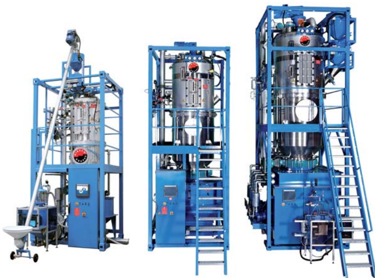
Bild 3: In den Vakuum-Aufschäumern der 'PREEX 6000'-Produktfamilie wird kugelförmig aufbereitetes Polystyrol-Granulat mittels Wasserdampf aufgebläht, sodass sich dessen Volumen um das Vierzig- bis Fünfzigfache vergrößert.
