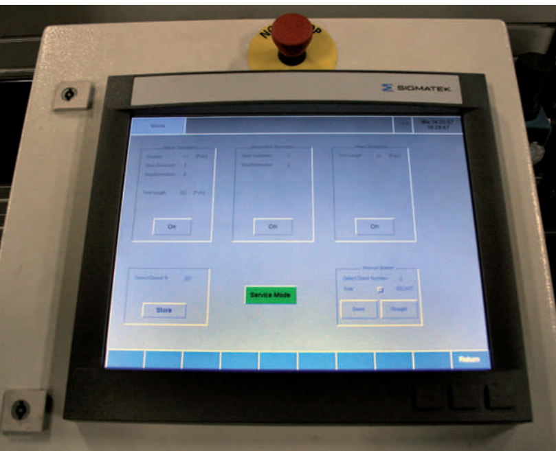
Bild 4: Auf dem Touchscreen kann jede einzelne Weiche parametrisiert werden.
