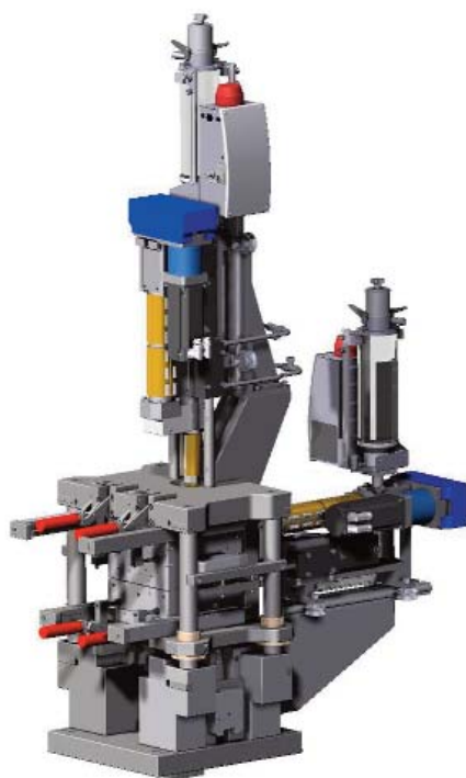
Bild 4: Die Entwicklung, Konstruktion und Fertigung des neuartigen Spritzgießmoduls von MMS dauerte nur knapp neun Monate. Das Werkzeug öffnet sowohl nach unten als auch nach oben. Das hat den großen Vorteil, dass der Metallstreifen starr in der Bandführung verbleiben kann und nicht aus der Kavität herausgehoben werden muss.
