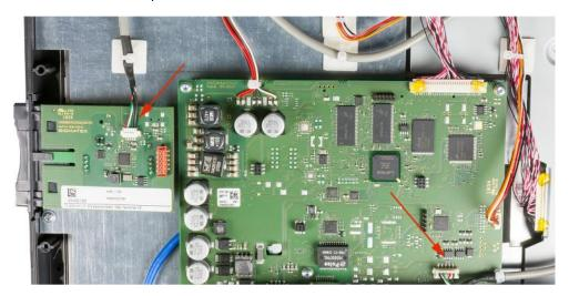
Das USB-Kabel muss mit den im Lieferumfang enthaltenen Klebesockeln und Kabelbindern gesichert werden.
