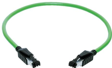
Vorkonfektioniertes, 4-poliges Systemkabel für Schleppkettenverlegung (IP20-Bereich), das auf seine industrielle Tauglichkeit geprüft ist. Das Verbindungskabel wird von der VNO (VARAN-BUS-NUTZERORGANISATION) für den IP20-Bereich empfohlen, da Echtzeit-Ethernet in der industriellen Automation im Gegensatz zu Office-Ethernet weitaus höhere Anforderungen an Robustheit und Qualität der Steckverbinder und Kabel stellt.
