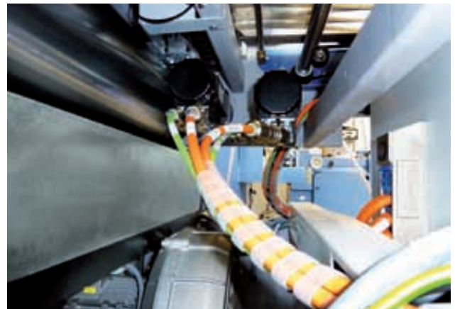
Links: Hinter den Kulissen der »BS Rotary 550 Servo« sorgen insgesamt fünf »DIAS-Drive 100«-Antriebssysteme für ein perfektes Zusammenspiel aller Komponenten.
