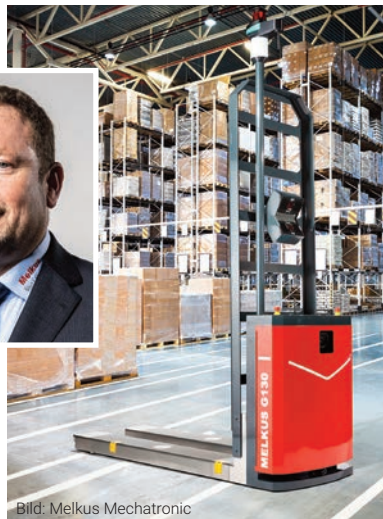
Das flexible Paletten-FTF von Melkus Mechatronic erkennt diverse Ladungsträgertypen automatisch und transportiert bis zu 1.200kg Nutzlast mit bis zu 1,5m/s. Die Automatisierungslösung kommt von Sigmatek.
