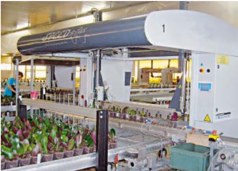
Der Speed-e-flex von Degravec wird als Übergabe-, Aufnahme- oder Platzierungsroboter verwendet
