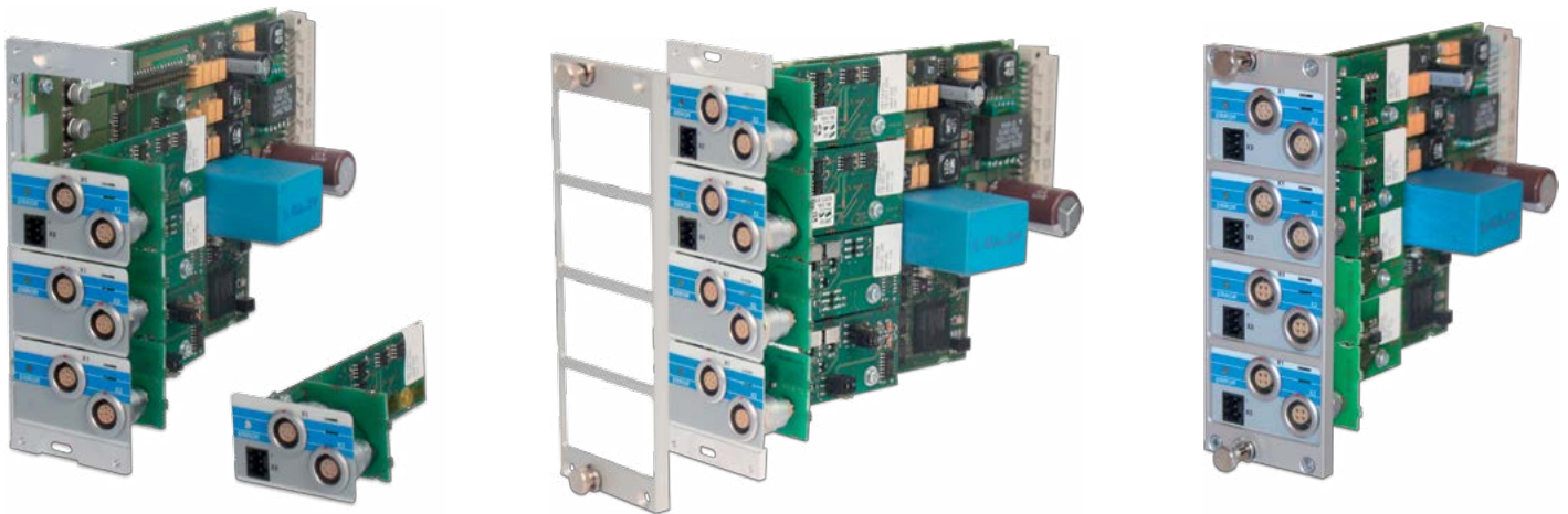
Der modulare Aufbau des Analogmoduls: Das Basismodul MSR 211 lässt sich anwendungsspezifisch mit bis zu vier Signalkonditionierungsmodulen bestücken.
