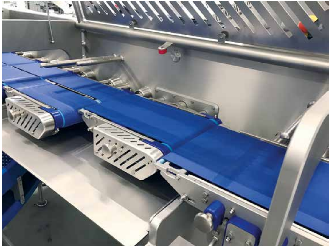
Im „Lane divider“ werden die gestapelten Burger in die richtige Konfiguration und Ausrichtung gebracht.
