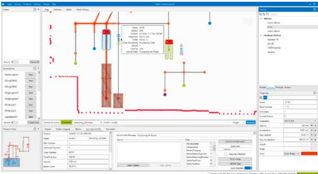
Die Visualisierung zeigt permanent eine vollständige Echtzeitdarstellung von Ort, Bewegungsrichtung und -geschwindigkeit sowie die Batterieladestände der einzelnen Fahrzeuge.
