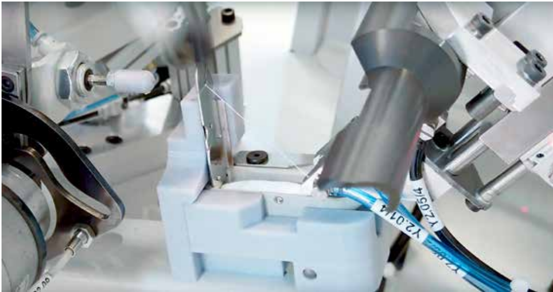
Automatisierte Schiffchen-Befüllung sowie Einstellung der Fadenspannung.
