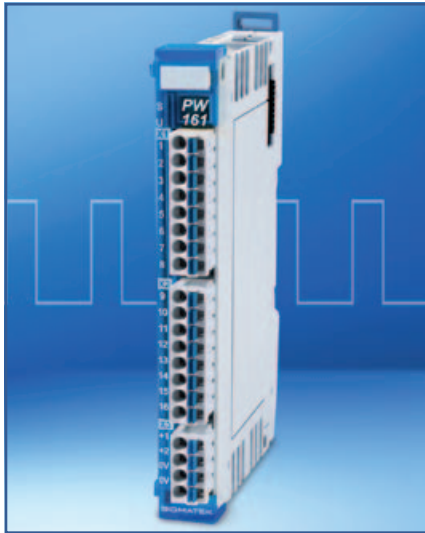
Das Modul PW 161: Mittels Pulsweitenmodulation schalten die 16 digitalen Ausgänge induktive Lasten bis zu 0,5 A – ideal für die Ventilansteuerung.
