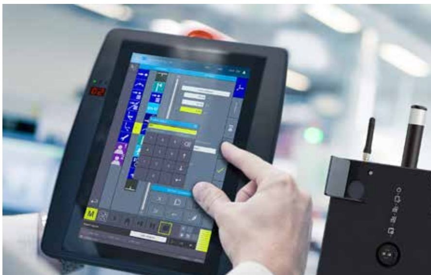
Effizient und sicher bedienen: das Wireless-Panel HGW 1033 mit 10,1 Zoll Multi-touch-Display und integrierten Safety-Funktionen in Kombination mit der Basisstation BWH 001 von Sigmatek.
