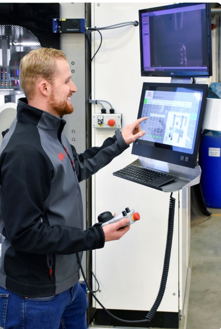
Bedienung und Beobachtung der Anlagen für die Additive Fertigung erfolgen mittels der ebenfalls in Lasal erstellten Visualisierung auf einem Multitouch-Bedienpanel TT 1933-S von Sigmatek mit 18,5" WXGA TFT-Farbdisplay.
