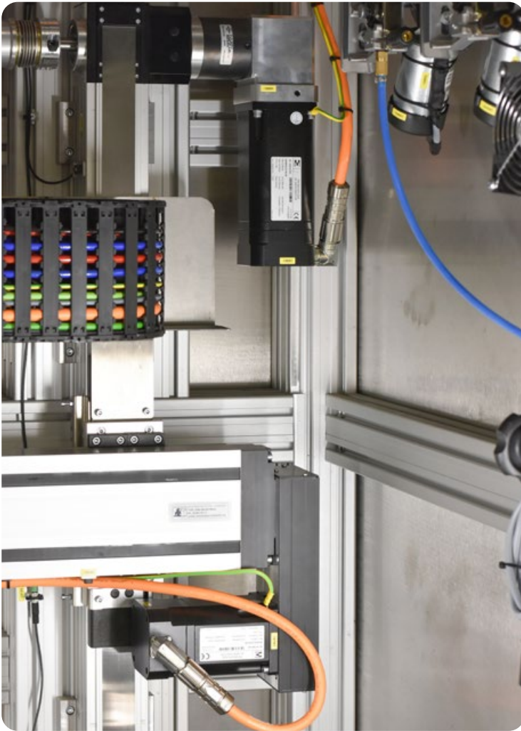
Für die Achsbewegungen innerhalb der Maschinen nutzt SBI die hochdynamischen bürstenlosen Drehstrom-Servomotoren der Baureihe DSM5 von Sigmatek.
