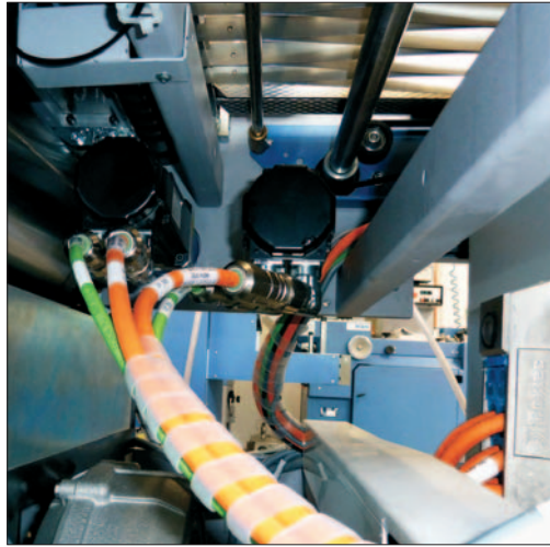
Servomotoren und Drives von Sigmatek positionieren die Papierbögen bei einer Geschwindigkeit von bis zu 165 m/min auf einen Zehntelmillimeter genau.
