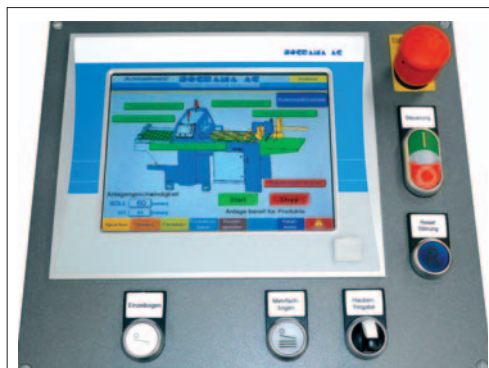
Ein zentrales Controlpanel mit Touchscreen steuert die gesamte Maschine
