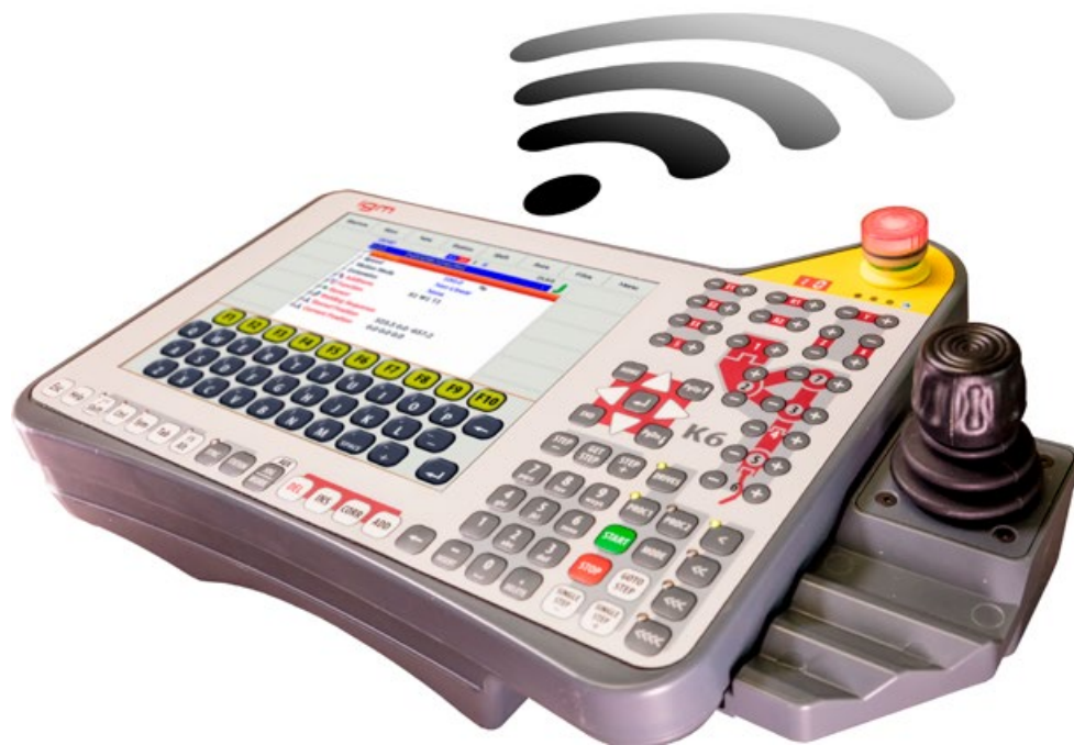
Sigmatek schuf das Programmierhandgerät K6 Wireless als WLAN-fähige Variante der bewährten kabelgebundenen igm-Eigenentwicklung.
