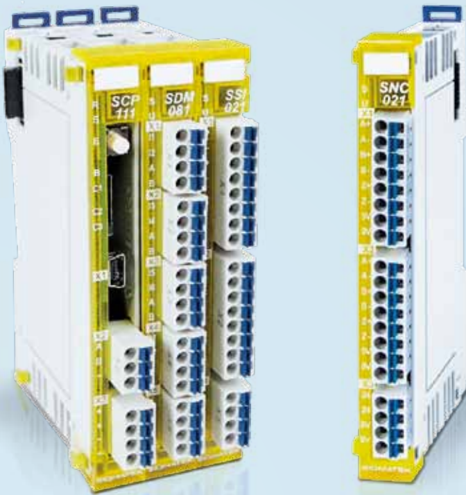
Neu im S-DIAS-Safety-Team ist das SNC 021 zur Auswertung von zwei Inkrementalgebersignalen zur sicheren Überwachung von Geschwindigkeit, Position, Drehrichtung und Beschleunigung.
