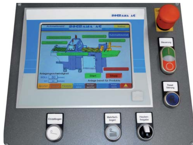
Bild 3: Ein zentrales Control-Panel mit Touchscreen steuert die gesamte Maschine.
