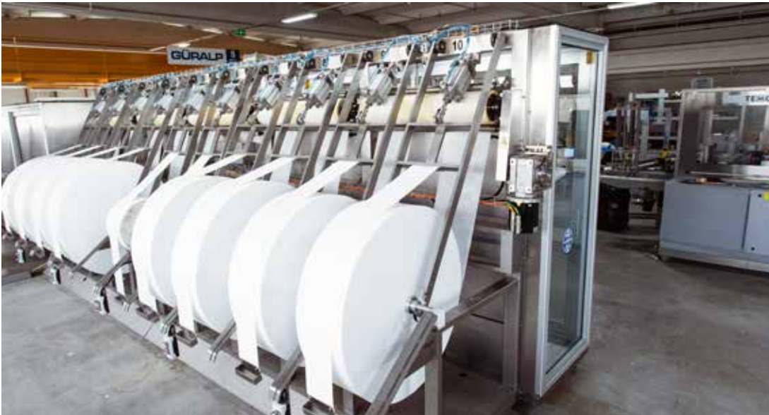
Bei der Feuchttuch-Verarbeitung sind zwischen 10 und 24 Vlies-Rollen im Einsatz.
