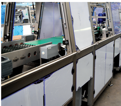
An dieser im Aufbau befindlichen Anlage wird die Raumausnutzung sichtbar. Sie lässt wenig Raum für umfangreiche Elektroinstallationen oder Verkabelungen.
