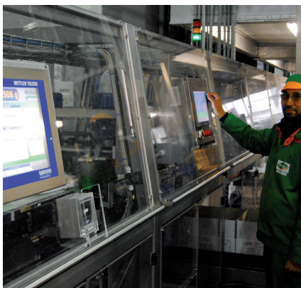
... durchlaufen die verschweißten Beutel in der CP 201 zahlreiche Kontroll- und Behandlungsschritte, ...
