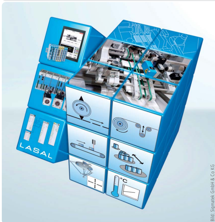
Bild 1: Lasal vereint alle Automatisierungsdisziplinen in einer Engineering-plattform: Steuerungsprogrammierung, Visualisierung, Antriebstechnik und Safety. Templates für verschiedene Roboter-Kinematiken, wie z.B. Knickarm, Delta, Scara und Portal, sind bereits enthalten.
