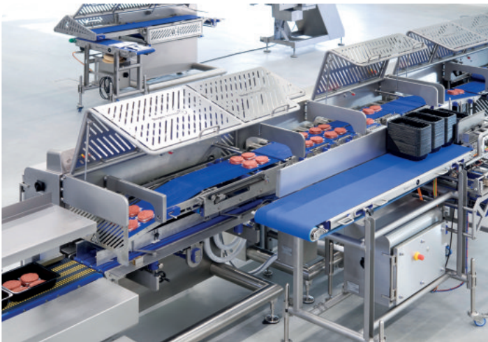
Entstapeln und Zuführen von Trays: Die Hamburger werden in der konfigurierten Stückzahl aufgenommen.
