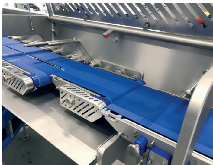
Im „Lane divider“ werden die gestapelten Burger in die richtige Konfiguration und Ausrichtung gebracht.
