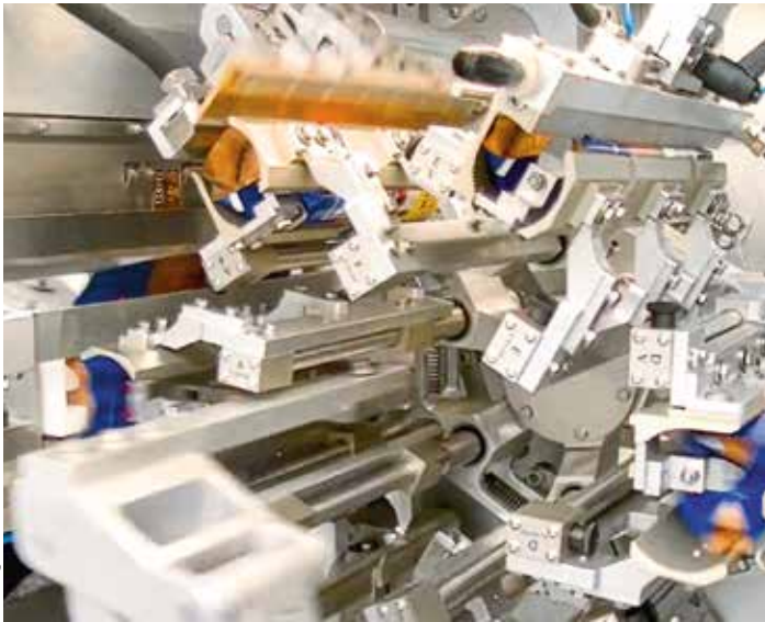
Hier hat die CM90 die Rentabilität erhöht: eine Siegelstation mit Karussell.
