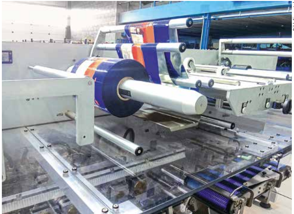
Kontinuierliche Rotation mit 2 Folienrollen durch einen automatischen Splicer.
