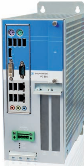
Das Pendant zu den Bedienterminals: Der Schaltschrank-PC 301 ist mit seinem Intel-Celeron-G530T-Prozessor und einem Solid-State-Drive auf dem Stand der Technik.
