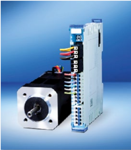
Auch das neue Achsmodul DC 061 mit etwa 300 Watt Nennleistung ist nur 12,5 Millimeter breit und integriert einen Standard-Resolver-Eingang (12 Bit) für eine kostengünstige Positionsrückmeldung.
