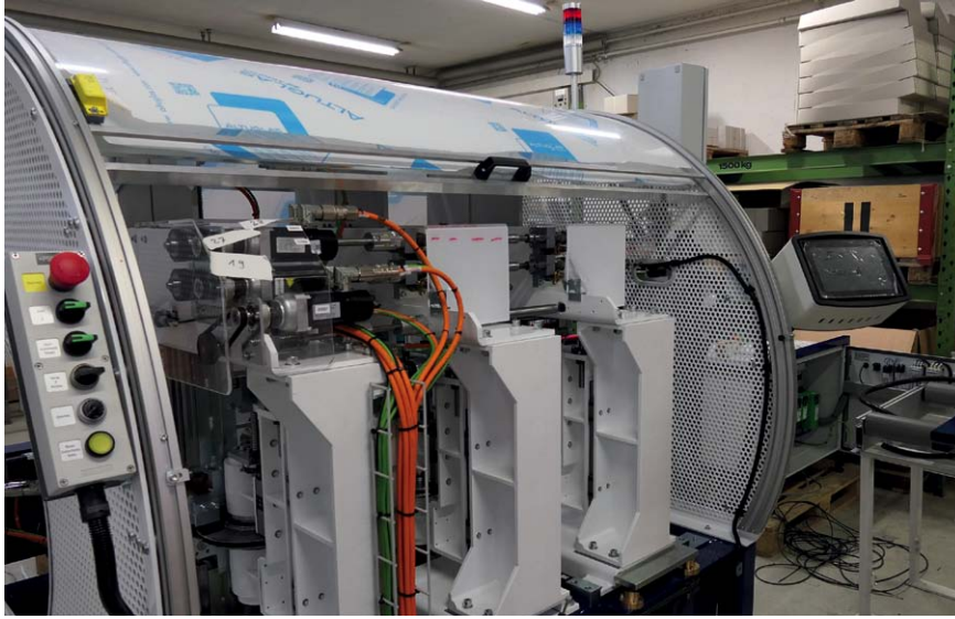
Neu entwickelte Einrollanlage für komplexere Profilgeometrien und kürzere Umrüstzeiten.
