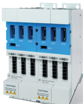
Ein Sechsaachsverbund in Baugröße 1, bestehend aus zwei Dreiachsmodulen mit einer Leistung von 4 kW, benötigt 150 mm × 240 mm × 219 mm inklusive Versorgung und Netzfilter. Die Achsmodule lassen sich einfach und werkzeuglos verbinden
