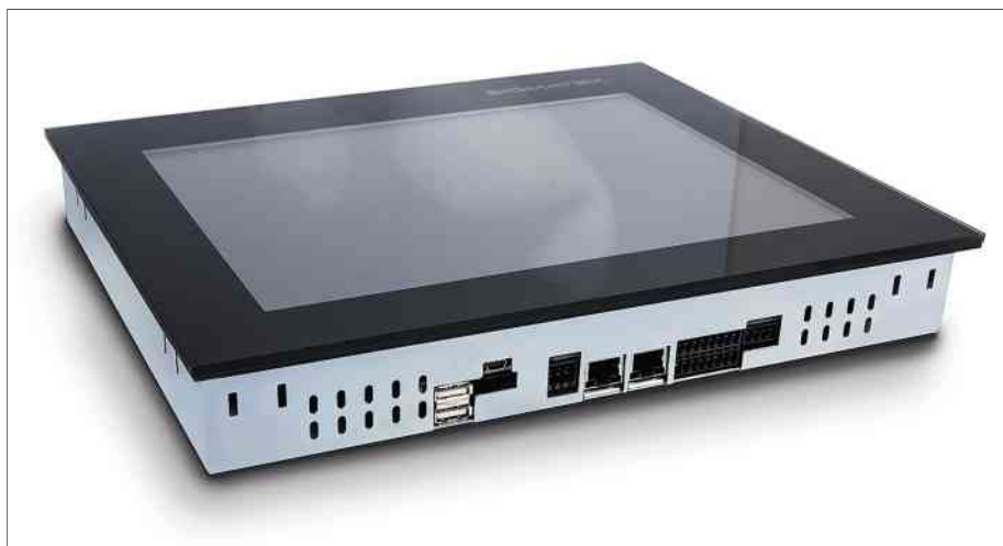
Mit 48 mm Einbautiefe und nach unten aufgeführten Schnittstellen und Anschlüssen ist die Multitouch-Panelserie einfach einzubauen und zu warten.
