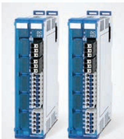
Die beiden neuen »S-Dias«-Module »DC 101« und »DC 102« schaffen als 25 mm breite Motorendstufen 10 A Dauerstrom und 20 A Spitzenstrom.
