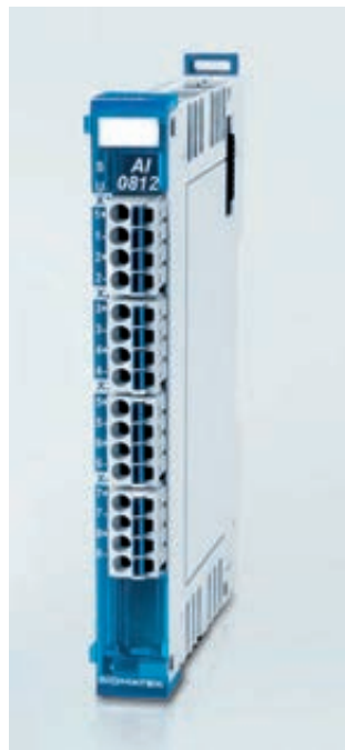
Das Eingangsmodul »AI 0812« kann auf nur 12,5 mm Baubreite die Messwerte von acht Thermo- bzw. Widerstandssensoren erfassen.
