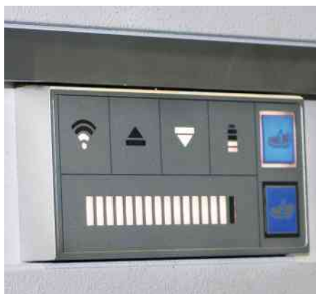
Eines der zahlreichen ergonomischen Details der neuen Maschine: Versetzbare Anzeigeeinheiten geben dem Bediener visuelles Feedback über seine MagicShoe-Aktivitäten.
