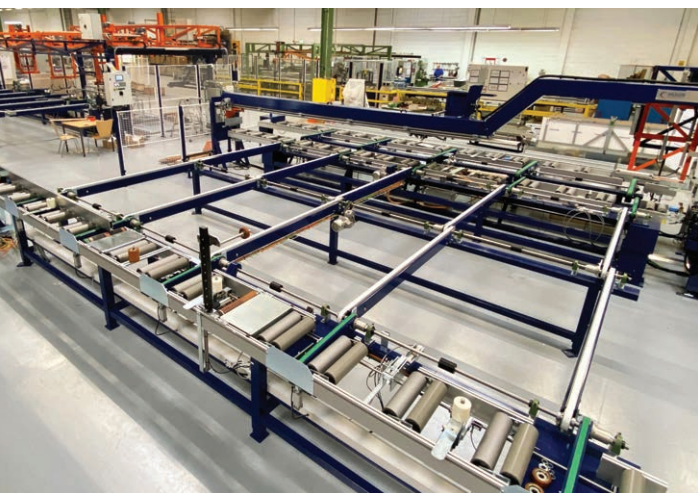
Der Schweizer Maschinenbauer Müller TB baut Anlagen zur vollautomatisierten Bearbeitung von Aluminiumprofilen für die Fensterproduktion.
