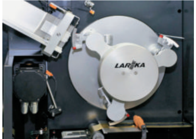
Die Banderole wird von einem Stapelmagazin (links) entnommen...
