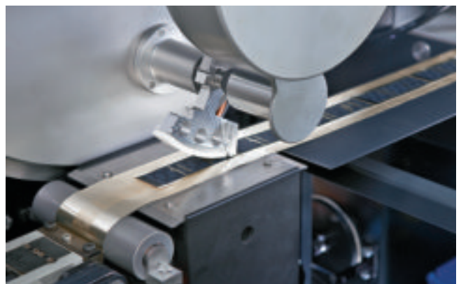
... und auf die von der Rolle zugeführte Metall-/Papierfolie geklebt, ehe die Schokolade-Minis darin eingewickelt...
