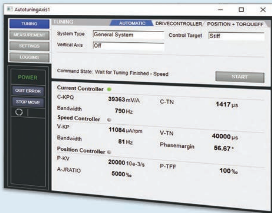
Für den Anwender sind die neuen »Autotuning«-Funktionen für Sigmateks »MDD 2000«-Servoantriebe komfortabel über ein Visualisierungsobjekt zugänglich.
